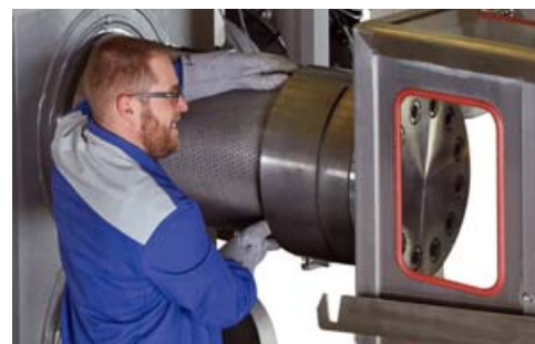
Sestava síta (CSC-R instalován pro horizontální tok taveniny)
